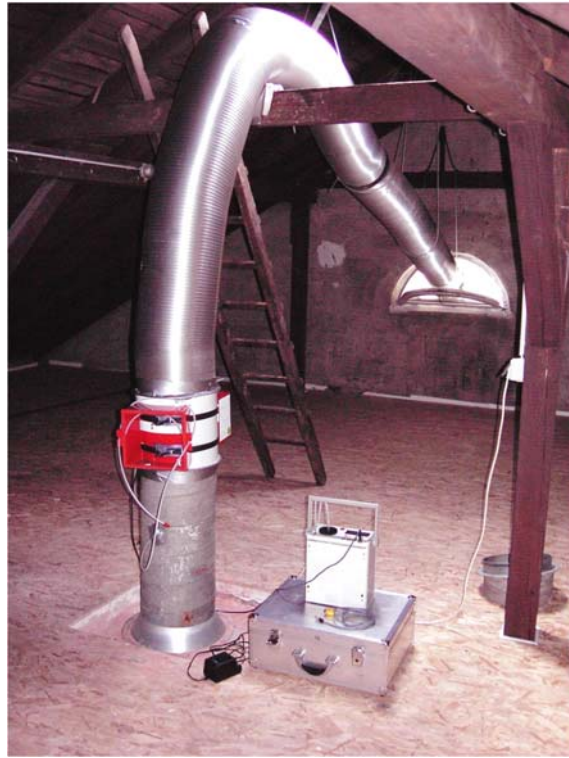
Lüfterversuch am Schornstein mit einem Blower-Door-Ventilator auf dem Dachboden
