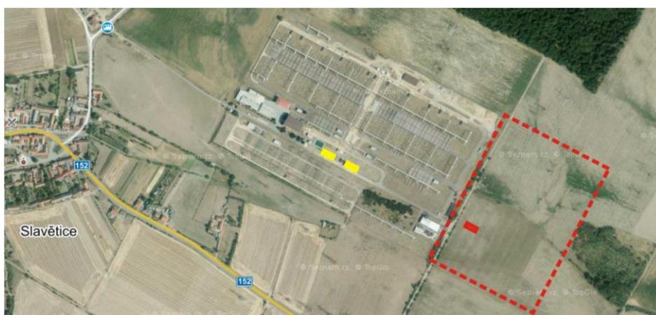
**Abb. 4 Platzierung der bestehenden Transformatoren (gelb) und des künftigen Transformators nach der Erweiterung (rot)**
