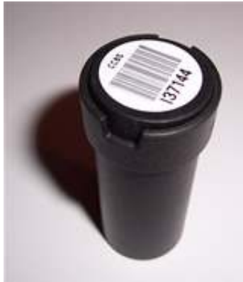
Abb.6: Beim Fördervorhaben eingesetztes passives Radondosimeter
