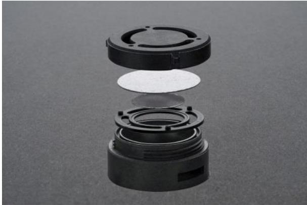
**Abb. 2:** Karlsruher Radonexposimeter (Einzelansicht)
