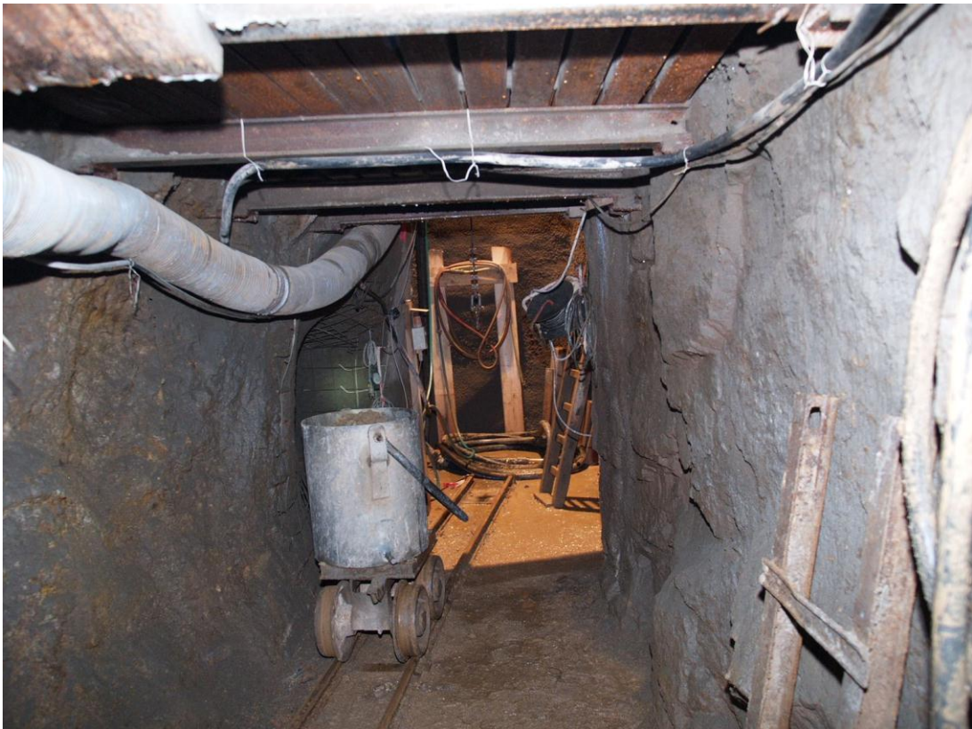
Abb. 7: Ausbau einer Altstrecke als Wetterrösche
