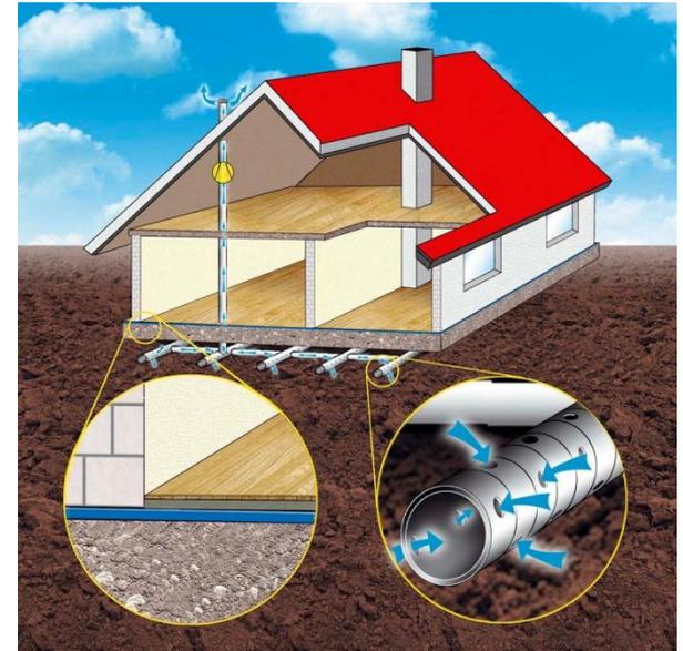
Abb.3 Radondrainage. Quelle: bfs.de 2012
